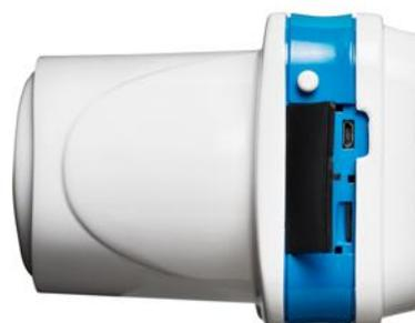
À l'intérieur de la porte de connexion USB et SD se trouvent un port Micro-USB, qui connecte la caméra 2WIN au tube KALEIDOS, et un support de carte MicroSD.
